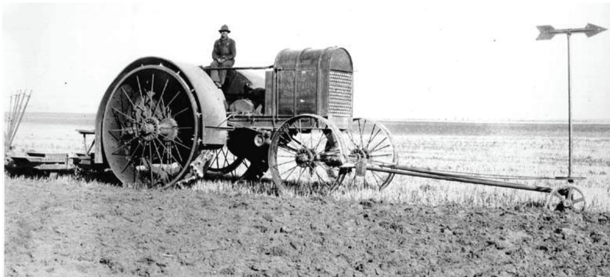
Slika 1.16 Prvi traktor sa automatskim vođenjem u operaciji obrade zemljišta (Heraud i Landge, 2009)
